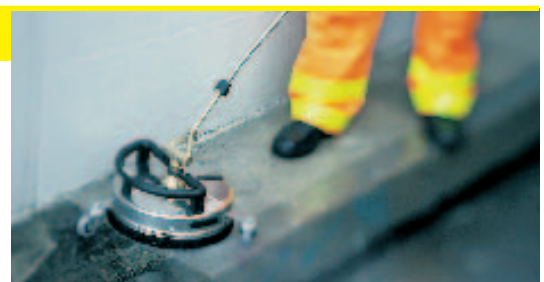
Wyposażenie do czyszczenia podłóg, z obrotową belką wyposażoną w dysze typu Power, osiąga nawet 10 razy wyższą wydajność powierzchniową niż metody tradycyjne.
